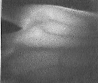
InGaAs VGAカメラで撮った手のひらの赤外線画像
