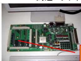
FPGAを用いたメモリ評価システム
