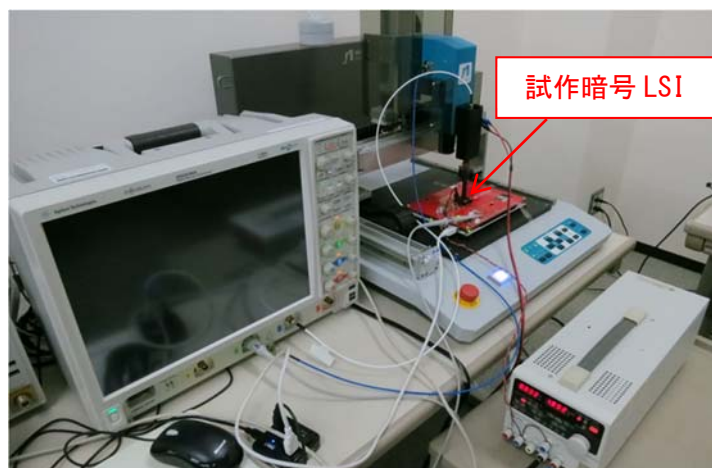
図 4. 電磁波を用いたサイドチャネル攻撃実験設備
