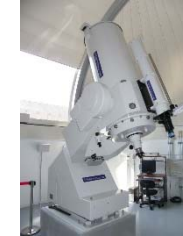
7m ドームを備えた天文台と60cm反射式光学望遠鏡(西村製作所製)
