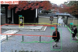
▲知的防犯カメラによる不審者検出実験の様子
