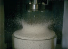
▲砂への物体高速貫入時の粒子飛散の様子
