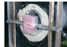
▲シリコンで作られた声帯レプリカ。ヒトと同様の発声リズムが再現可能。
