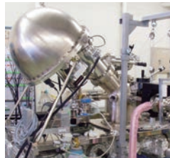
▲高分解能光電子分光装置:物質から飛び出した電子を精密に測定します。
