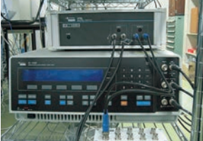
▲誘電線とスペクトロスコープ法に用いるインピーダンスアナライザー。広い時間領域のダイナミクス測定が可能。
