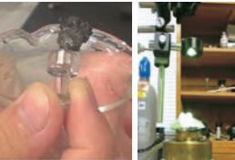
▲（左）マイクロ波（電子レンジ）を使用してわずか15分間で作製した鉄（右）レーザー誘起プラズマ
