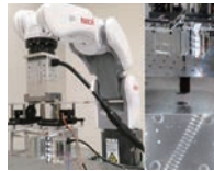
▲触覚画像センサを用いたロボットによるネジ締め作業
