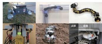
▲左上：水陸両用ロボット機構／上中：管内移動ロボット／右上：蛇型移動ロボット 左下：空気圧劣駆動グリッパー／下中：多脚移動ロボット／右下：配管図作成へのAI活用
