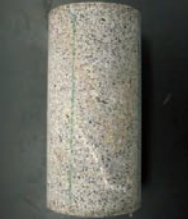
▲断層形成途上の花崗岩試料。白い部分が将来、断層となって破壊する。
