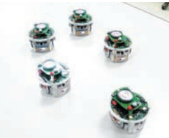
▲小型移動ロボット群のフォーメーション走行制御実験
