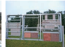
▲外装材の耐凍害性に関する暴露試験（旭川、北方建築総合研究所）
