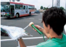
▲道路沿道空気の捕集、ヒトの鼻と機械の双方を使って道路空気の汚染の程度を評価しています。
