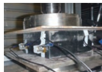
▲ゴム支承健全性評価の室内実験の様子
