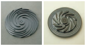
▲マイクロ加工技術により試作した直径10mmのシリコン製スプリッターインベラー翼・反動タービン翼と流体シール構造（回転数90万rpmの設計点性能は圧力比2、断熱効率0.5）
