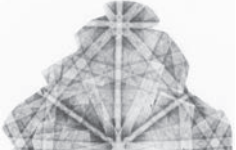
▲走査型電子顕微鏡の電子線後方散乱により得られた電子線回折図形
