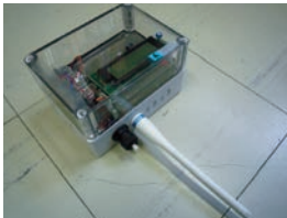
▲斜面崩壊監視ネットワークの構成要素となるセンシングノードの構成例
