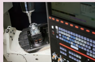
■ マシニングセンターで複雑な三次元加工物を作製
