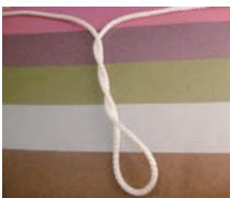
▲紐をねじると、座屈と呼ばれる不安定性によって特徴的な構造が出現する。電話線からDNAのスーパーコイルにまで共通する普遍的なメカニズム。
