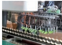
▲複数キュウリを同時に箱詰めするロボットシステム
