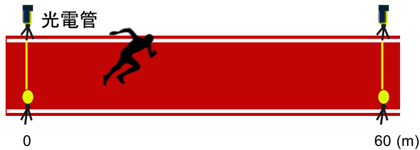
図 4. 60 m 走における実験配置図
