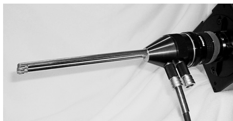
図1 計測に用いたステレオ側視型硬性内視鏡 (永島医科器械)
