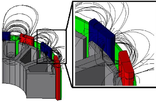
Fig. 4. Leakage magnetic flux.
